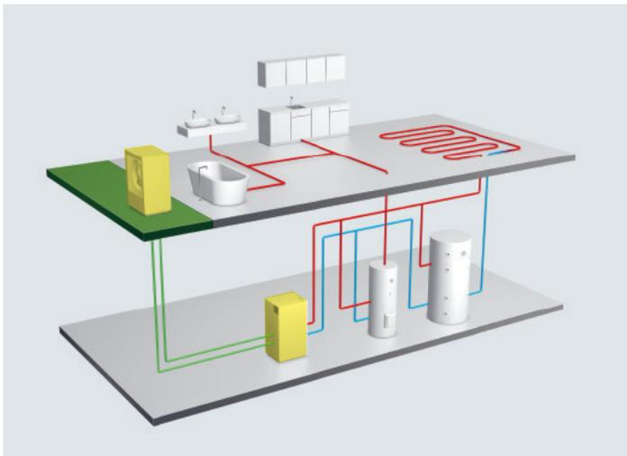
Schematische Darstellung von Raumheizung und Warmwasseraufbereitung bei einem Einfamilienhaus mit der Oertli M Flex 9SR Split-Luft-Wasser-Wärmepumpe.
